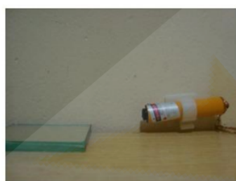
(a) Montagem experimental do espelho de Lloyd.
